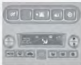
Controle eletrônico do condicionador de ar
