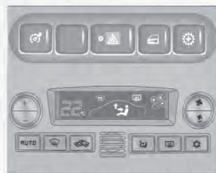
Controle eletrônico do condicionador de ar
