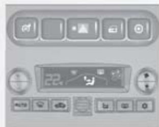
Controle eletrônico do condicionador de ar
