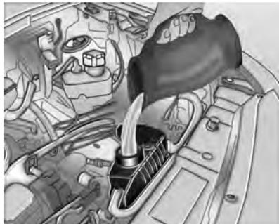
Se não houver vazamento, verifique o funcionamento da ventoinha do motor. Seu veículo está equipado com uma ventoinha elétrica. Se houver superaquecimento do motor, ela terá de ser acionada. Se isto não acontecer, será preciso efetuar o conserto. Desligue o motor. Se o problema não for identificado, mas o nível do líquido de arrefecimento não estiver no máximo, adicione ao reservatório de expansão uma mistura de água potável e aditivo para radiador. Ligue o motor quando
