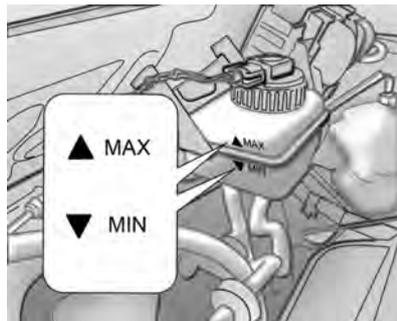
Verifique o fluido de freio mensalmente e quando a lâmpada indicadora de nível no painel de instrumentos (⚠) acender.
