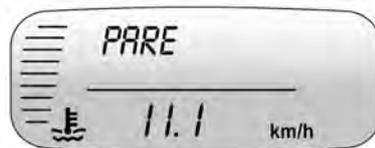
Esta mensagem é exibida e soa um alarme se o sistema de arrefecimento do motor atingiu temperaturas inseguras para operação. Pare e desligue o veículo o mais rápido possível para evitar danos graves. Esta mensagem é excluída quando o motor esfriar a uma temperatura segura de operação.
