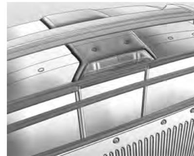
As luzes do compartimento de carga estão localizadas no compartimento de luz de freio. Para ligá-las ou desligá-las, pressione o botão no painel de instrumentos ao lado do botão de luz de advertência de perigo.
