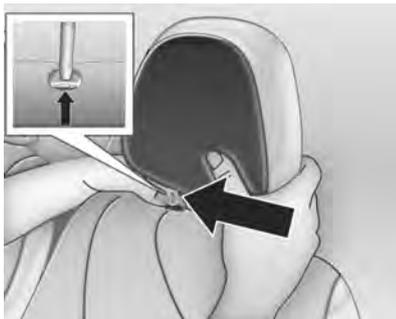
Para ajustar o apoio de cabeça pressione o botão de destravamento (seta) e deslize o apoio de cabeça manualmente para cima ou para baixo. O apoio de cabeça pode ser posicionado em três alturas diferentes.
