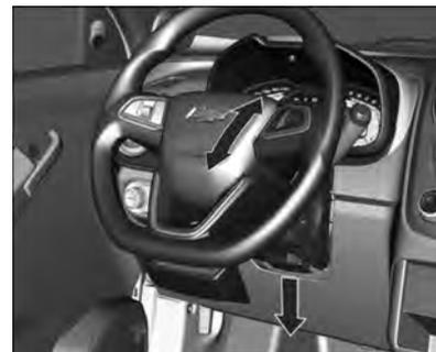
Destrave a alavanca, ajuste a altura do volante e trave-a novamente, e assegure-se de que esteja totalmente travada.
