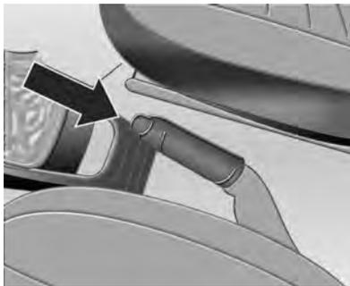
Para soltar o freio de estacionamento, puxe a alavanca ligeiramente para cima, aperte o botão na sua extremidade (seta) e empurre-a para baixo até a lâmpada indicadora (ⓘ) do painel desligar.
