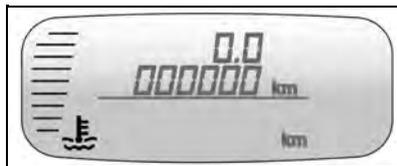
Exibe a temperatura do líquido de arrefecimento do motor.
