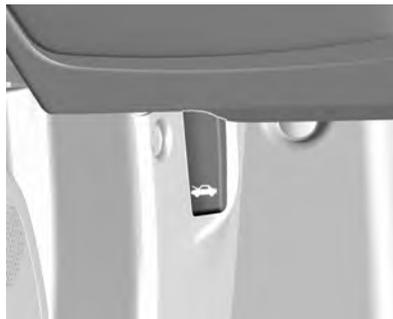
Para abrir o capô, puxe a alavanca da trava (situada no lado esquerdo), embaixo do painel de instrumentos.
