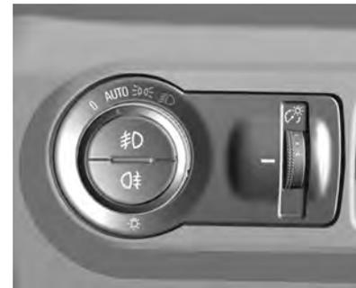
Para veículos com farol de neblina dianteiro e luz de neblina traseira controle automático de iluminação.
