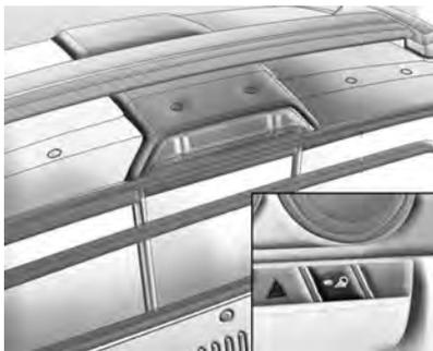
As luzes do compartimento de carga estão localizadas no compartimento da luz de freio. Para ligá-las ou desligá-las, pressione o botão no painel de instrumentos, ao lado do botão da luz do sinalizador de advertência.
