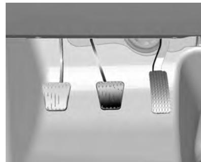
Quando se aperta o pedal do freio, a luz correspondente se acende nas lanternas traseiras e na luz de freio auxiliar do vidro traseiro.
