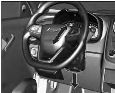
Destrave a alavanca, ajuste a altura do volante e trave-a novamente, e assegure-se de que está totalmente travada.
