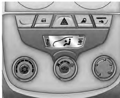
Além do fluxo de ar natural que entra no veículo pelas entradas de ar no painel frontal. Quando o veículo se encontra em movimento, o ventilador pode ser usado para aumentar o fluxo de ar.
