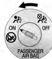
Para reativar o airbag dianteiro do passageiro, insira a chave de ignição no interruptor, pressione-a para dentro e mova o interruptor até a posição ON (ligado).
