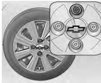
16. Instale os parafusos e aperte-os parcialmente.
