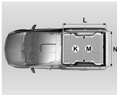
K. Largura interna do compartimento de carga - 1.340 mm (com proteção da caçamba - 1.324 mm)
