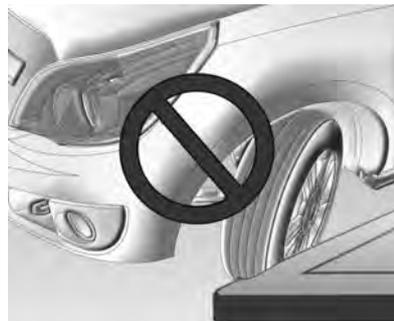
Os impactos contra as guias da calçada podem causar lesões nas rodas e pneus por dentro. Há risco de acidentes a alta velocidade devido a danos externos ocultos nos pneus. Portanto, se for preciso subir em uma guia, faça-o lentamente e no ângulo reto, se possível.
