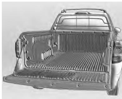
O limite de carga sobre a tampa deve ser seguido, ou a tampa e o chassi podem ser danificados.
