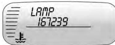
Esta mensagem é exibida se for preciso trocar uma das lâmpadas dos sinalizadores de direção.
