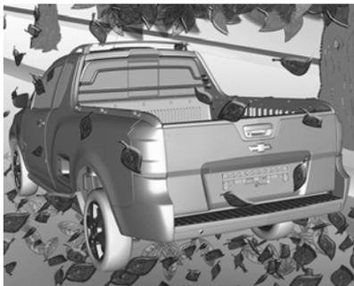
Evite estacionar em grama seca, arbustos, gotas de combustível ou outro material inflamável quando o sistema de escapamento estiver aquecido. Dependendo da situação, isto pode causar um incêndio.
