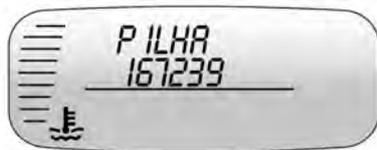
Esta mensagem é exibida quando a bateria do controle remoto precisa ser substituída.
