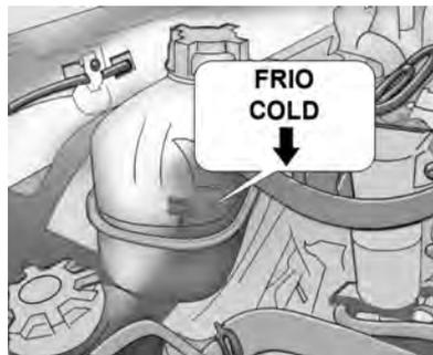
Raramente ocorre perda em um sistema de arrefecimento de circuito fechado. Portanto, raramente é necessário completar o nível, mas ele deverá ser verificado semanalmente, com o veículo em uma superfície plana e com o motor frio.
