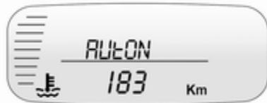
A autonomia exibe a distância aproximada que o veículo pode percorrer sem reabastecer. A estimativa da autonomia baseia-se no consumo médio de combustível do veículo no histórico recente de condução e na quantidade remanescente de combustível no tanque. A autonomia pode ser zerada mantendo o botão **R** pressionado por 2 segundos.
