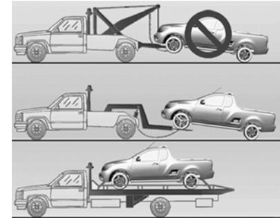
Em situações de emergência que exijam o reboque do veículo, procure, de preferência, empresas especializadas com carros-guincho ou a assistência oficial da rodovia, usando veículos de reboque que tenham apoio para as rodas ou plataforma para receber o automóvel.
