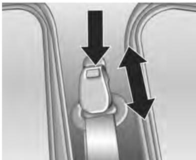
Para efetuar o ajuste, pressione o botão (seta esquerda) e ajuste a altura de acordo com sua estatura (seta direita).
