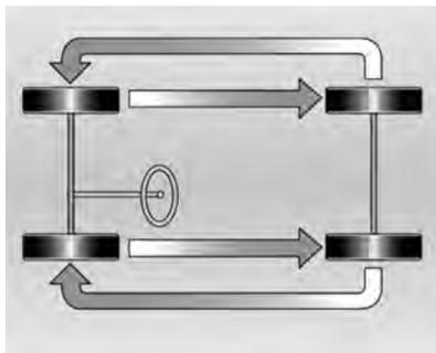
Os pneus dianteiros e traseiros manifestam fenômenos de trabalho diferentes e podem apresentar desgaste diferente na dependência direta de vários fatores: superfície da pista, modo de dirigir, alinhamento da suspensão, balanceamento das rodas, pressão dos pneus etc.
