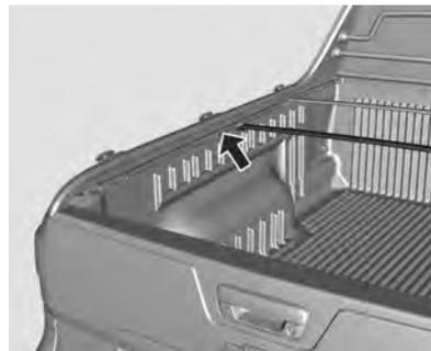
2. Coloque a outra extremidade da travessa traseira no trilho. Alinhe as extremidades da travessa com as etiquetas localizadas na parte superior do trilho.
