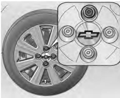
16. Instale os parafusos e aperte-os parcialmente.
