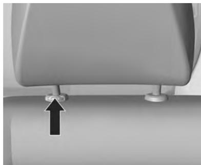
Para remover o apoio de cabeça, pressione o botão de destravamento (seta) e puxe o apoio de cabeça.
