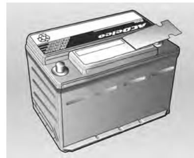
A bateria ACDelco equipada em seu veículo não precisa de manutenção. Se o veículo não for usado por 30 dias ou mais, desconecte a bateria conforme o procedimento descrito em *Conexão/desconexão da bateria*, para evitar que ela descarregue.
