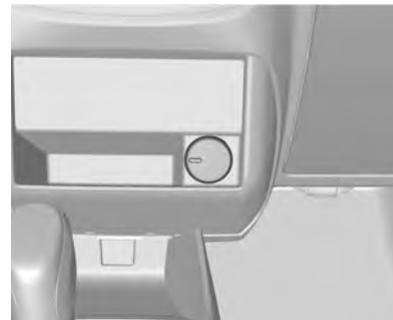
Existe apenas uma tomada de 12 V no painel central que permite a conexão de aparelhos elétricos, como carregadores de telefones celulares e outros acessórios. O fornecimento de energia máximo para os acessórios não deve exceder a 120 W para tomada de energia.
