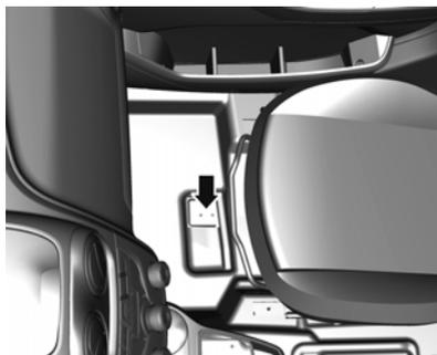
O veículo possui um local adequado para a instalação do suporte para o extintor de incêndio abaixo do banco do passageiro, sob o carpete do assoalho conforme ilustração. O extintor de incêndio e o suporte podem ser adquiridos separadamente e instalados em uma concessionária Chevrolet.
