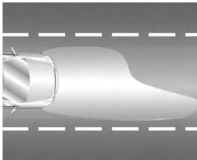
O fecho de luz do farol baixo é projetado de modo a iluminar determinadas regiões com maior intensidade, privilegiando a visualização das placas de sinalização e reduzindo o efeito de ofuscamento para os condutores de veículos no sentido contrário. Essas regiões e intensidade de luz são normatizadas (as resoluções CONTRAN 227/07 e 294/08) e os faróis do seu veículo foram projetados para atender às regras de segurança e fornecer melhor desempenho de iluminação do veículo. Portanto, eventuais
