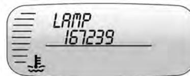
Esta mensagem é exibida se for preciso trocar uma das lâmpadas dos sinalizadores de direção.
