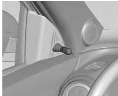
Os espelhos retrovisores externos são ajustáveis com facilidade através das alavancas de ajuste dentro do veículo. Para efetuar o ajuste de posição, mova a alavanca de ajuste instalada no painel da porta.
