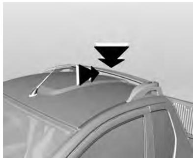
A barra superior no teto não foi projetada para nenhum tipo de carga e não protege os ocupantes do veículo em caso de capotamento.
