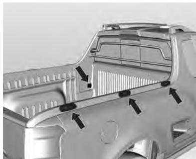
Nas partes externa e interna do compartimento de carga, há ganchos para direcionar cordas ou prendedores plásticos para imobilizar a carga.
