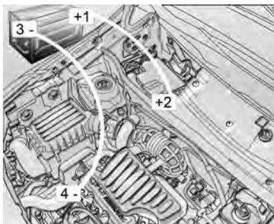
4. Conecte os terminais na sequência indicada:
