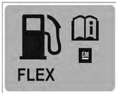
A etiqueta adesiva acima contém uma indicação do tipo de combustível e se localiza na portinhola do bocal de enchimento de combustível do veículo.
