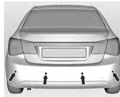
O sensor de estacionamento facilita estacionar medindo a distância entre o veículo e obstáculos na parte traseira do mesmo fornecendo avisos sonoros. Entretanto, o motorista é totalmente responsável pela manobra de estacionamento.
