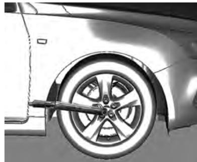
1. Dobre a chave de roda e instale-a assegurando-se de que ela esteja assentada de forma segura e afrouxe cada parafuso meia volta.
