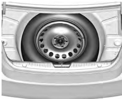
O pneu reserva está localizado no compartimento de carga sob o revestimento do assoalho. Ele é preso ao recesso com uma porca borboleta.
