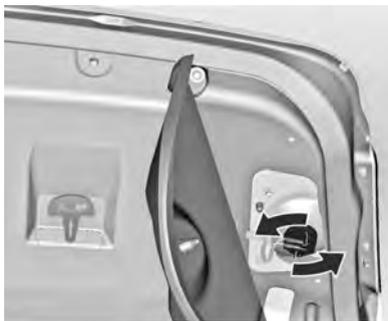
1. Remova o painel interno da tampa do compartimento de carga.
