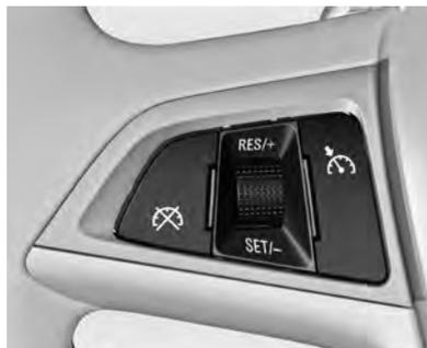
**On/Off (Liga/Desliga)** : Aperte para ligar e desligar o controle de velocidade de cruzeiro.
