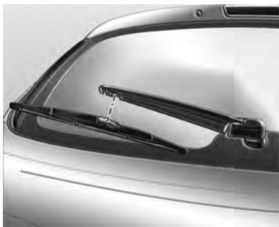
Levante levemente a haste do limpador. Desencaixe a palheta do limpador conforme ilustrado na figura e retire-a.
