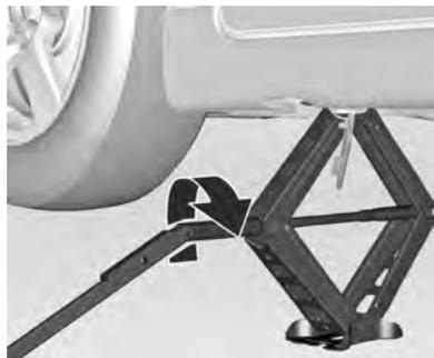
Conecte a chave de roda e, com o macaco corretamente alinhado, gire-a até que o pneu se erga do chão.
