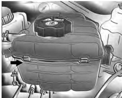
Se o sistema de arrefecimento estiver frio, o nível do líquido de arrefecimento deverá estar próximo à marca mostrada na figura. Caso o nível esteja abaixo dela, aguarde até que o sistema de arrefecimento esteja frio, remova a tampa do reservatório e encha-o até a marca mostrada na figura, adicionando uma mistura de água neutra e aditivo para radiador (consulte Líquido de arrefecimento do motor). Instale a tampa e aperte-a firmemente.
