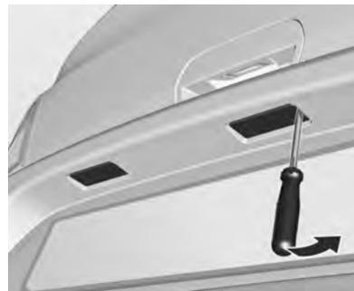
1. Inserir uma chave de parafusos no alojamento da lâmpada, pressionar para o lado e soltar a mola.
