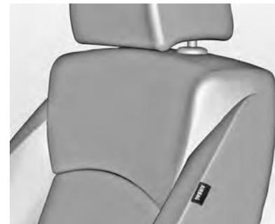
O sistema de airbags laterais consiste em um airbag em cada encosto do banco dianteiro. Ele pode ser identificado pelas palavras SRS SIDE AIRBAG.
