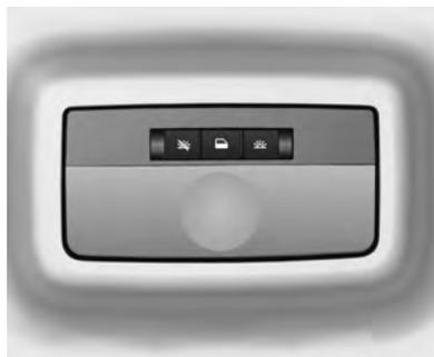
Durante a entrada e a saída do veículo, as luzes de cortesia acendem automaticamente e desligam após um tempo. Ela acende por um curto período mesmo se a chave for removida da ignição.
