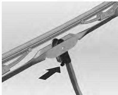
Levante a alavanca do limpador. Pressione a porca de travamento, puxe a palheta para baixo e remova-a.
