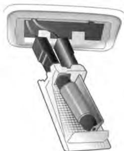
Pressione a lâmpada ligeiramente na direção do clipe de mola e remova-a.
