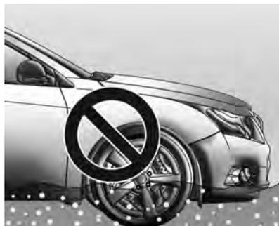
As áreas alagadas deverão ser evitadas em qualquer situação. Uma via coberta de água impede que o motorista avalie as condições de maneira adequada. Os danos causados pela entrada de água no motor e em outras partes do veículo não são cobertos pela garantia.
