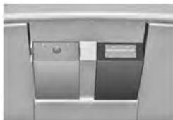
Sob a tampa do console central, há um soquete USB para a conexão de fontes de áudio externas.
