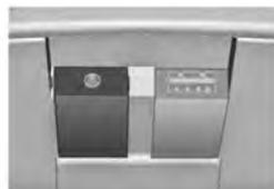
Sob a tampa do console central há um soquete AUX para a conexão de fontes de áudio externas.
