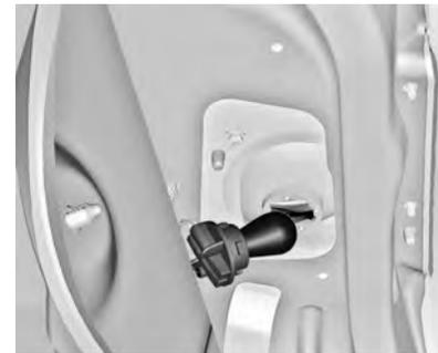
3. Remova o suporte da lâmpada. Empurre a lâmpada levemente para dentro do soquete, gire no sentido anti-horário, remova-a e troque-a.
