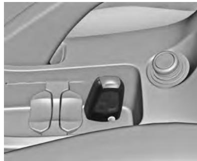
Abra a tampa na parte inferior do suporte para copos, no console central. Desdobre a parte da chave eletrônica e insira-a conforme mostrado na figura.
