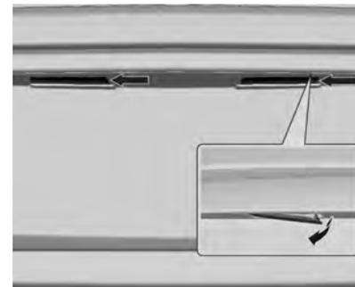
1. Retire a lâmpada com uma chave de fenda.
