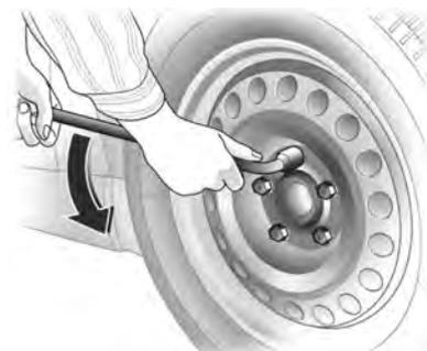
1. Instale a chave de roda assegurando-se de que ela esteja assentada de forma segura e afrouxe cada parafuso meia volta.
