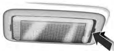
1. Retire a lâmpada com uma chave de fenda.
