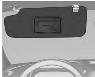
Os para-sóis têm espelhos integrais e podem ser baixado ou girados para o lado, para evitar o ofuscamento.
