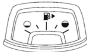
Quando a ignição está ligada, o indicador de combustível indica a quantidade de combustível restante no tanque de combustível do veículo.
