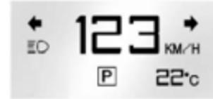
**Formato um:** Esta indicação apresenta o valor do velocímetro (em unidades inglesas ou métricas), indicação do sinal de direção, indicação do farol alto, posições da transmissão, temperatura do ar externo.
