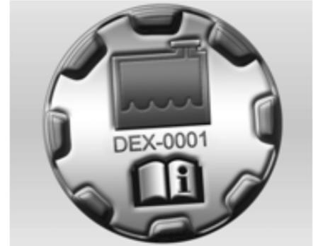
3. Gire a tampa da vareta medidora do líquido de arrefecimento do motor no sentido anti-horário e lentamente remova a vareta medidora.
