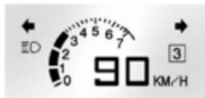
**Formato três:** Esta indicação inclui as informações do Formato Um junto com um tacômetro circular, sem a temperatura do ar externo.
