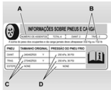
A etiqueta de informações sobre pneu e carga é fixada na coluna central do veículo (coluna B) lado do motorista. Com a porta do motorista aberta, você verá a etiqueta fixada na coluna da porta.
