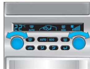
Controle eletrônico do condicionador de ar
