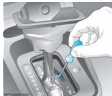
4. Empurre a garra para fora com o auxílio de uma chave de fenda e mova a alavanca seletora para uma posição diferente de **P**.
