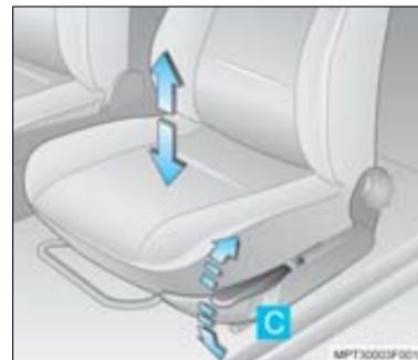
**Regulagem da posição da altura do assento do banco do motorista:** para elevar o assento, puxe a alavanca de regulagem (C), situada na parte lateral do assento. Para abaixar o assento, empurre a alavanca.
