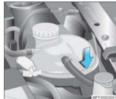
Se você decidir abrir o compartimento do motor, verifique o tanque de expansão do líquido de arrefecimento.
