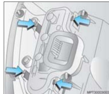
5. Pressione simultaneamente as lingüetas de retenção localizadas na parte externa do soquete e remova o soquete da lâmpada.
