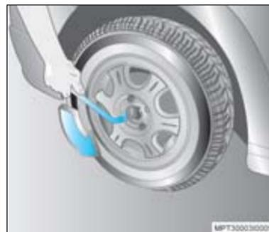
8. Com a chave de roda, afrouxe os parafusos 1/2 a 1 volta, mas não os remova.
