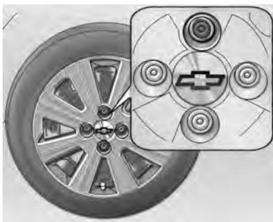
16. Instale os parafusos e aperte-os parcialmente.
