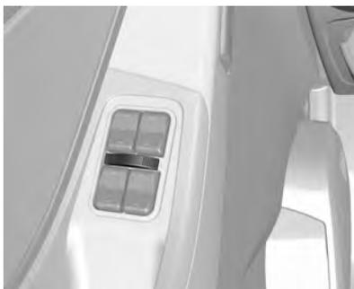
O interruptor localiza-se entre os interruptores dos vidros elétricos localizados do lado esquerdo do motorista. Para a esquerda (superfície vermelha visível) - os vidros traseiros não podem ser acionados através dos interruptores das portas traseiras. Para a direita (superfície verde visível) - os vidros traseiros podem ser acionados com os interruptores das portas traseiras.
