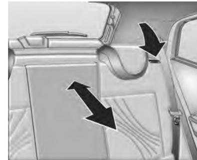
O encosto do banco traseiro pode ser travado em várias posições <sup>1)</sup>. Para ajustar, pressione o botão de destravamento e coloque o encosto na posição desejada.
