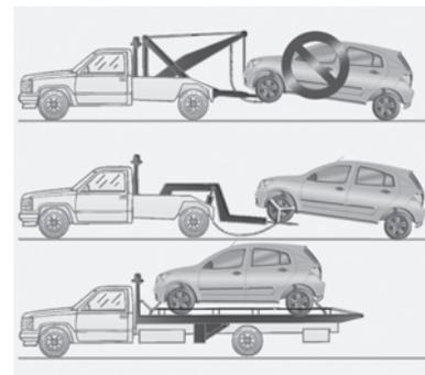
Em situações de emergência que exijam o reboque do veículo, procure, de preferência, empresas especializadas com carros-guincho ou a assistência oficial da rodovia, usando veículos de reboque que tenham apoio para as rodas ou plataforma para receber o automóvel.
