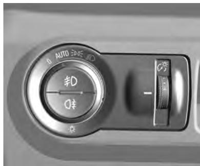
Para veículos com luz de neblina traseira e farol de neblina dianteiro, e controle automático de iluminação.
