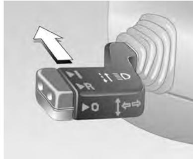
Com botão dos faróis na posição **D**, o farol alto é obtido empurrando-se a alavanca para a frente. Par voltar para a condição de farol baixo, a alavanca deve ser empurrada para a frente novamente.
