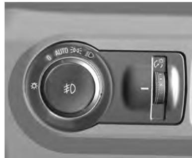
Para veículos com farol de neblina dianteiro e controle automático de iluminação.
