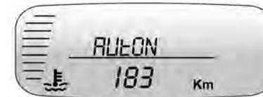
A autonomia exibe a distância aproximada que o veículo pode percorrer sem reabastecer. A estimativa da autonomia baseia-se no consumo médio de combustível do veículo no histórico recente de condução e na quantidade remanescente de combustível no tanque. A autonomia pode ser zerada mantendo o botão **R** pressionado por cerca de dois segundos.
