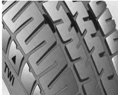
Por razões de segurança, os pneus devem ser trocados quando a profundidade dos sulcos se aproximar de 3 mm.
