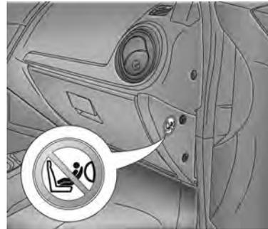
Veículos com airbag no banco dianteiro podem ser identificados com a palavra "airbag" na etiqueta adesiva na lateral do painel de instrumentos, ela está visível quando a porta do passageiro está aberta.
