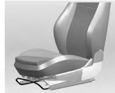
Ajuste do banco dianteiro. Para ajustar o banco para frente/para trás, puxe a alavanca de regulagem para cima, deslize o banco para a posição desejada e solte a alavanca travando-o.
