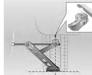
10. Ao levantar o macaco, verifique se a borda da sua base está encostando no chão e coloque-o diretamente embaixo do recesso da lâmina.
