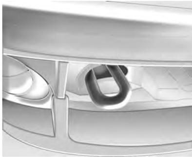
O gancho de reboque só pode ser usado para esta função, não para desatolar o veículo.
