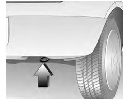
O engate de reboque fica localizado na parte traseira do automóvel (lado direito). Coloque o cabo de reboque no engate.
