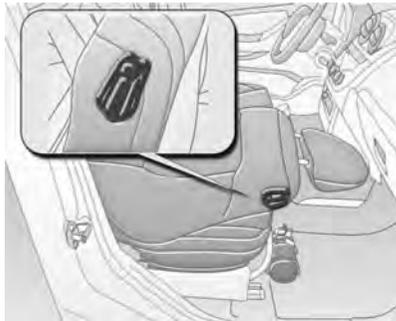
O encosto do banco dianteiro do passageiro pode ser rebatido até a posição horizontal do encosto puxando a alavanca localizada na parte superior externa do encosto. Isto pode ser utilizado em conjunto com o rebatimento parcial do banco traseiro (se equipado) para carregar objetos mais longos - recurso opcional em alguns modelos.
