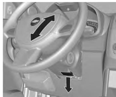
Destrave a alavanca, ajuste o volante e trave-a novamente, e assegure-se de que está totalmente travada.
