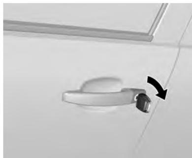
Gire a chave no sentido horário. Será acionado o travamento das portas e da tampa de acesso ao bocal de abastecimento do tanque de combustível. O alarme não é ativado com o travamento do carro com a chave.
