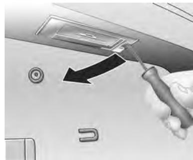
1. Remova o suporte da lâmpada com uma chave de fenda, fazendo pressão para o lado e para baixo (veja figura) até ele soltar.
