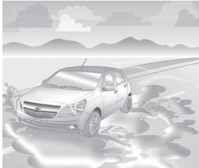
O excesso de água poderá acumular sob os pneus de modo que eles não tenham contato com a pista e isto é muito perigoso. Isto poderá acontecer se houver muita água na pista e se você estiver em alta velocidade. Quando o veículo está aquaplanando, há pouco ou nenhum contato do pneu com a pista.
