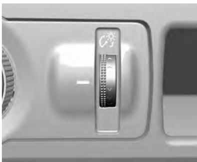
Este recurso controla a intensidade das luzes do painel de instrumentos. O botão localiza-se próximo do controle de iluminação externa. Gire o botão para cima ou para baixo para aumentar ou diminuir as luzes do painel de instrumentos.
