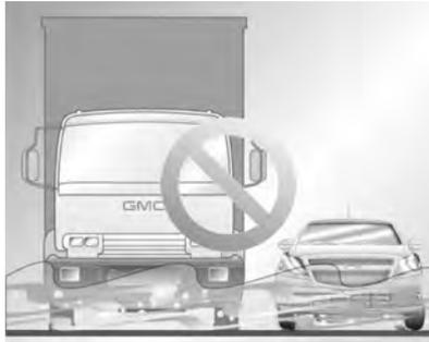
Se realmente for preciso atravessar um trecho alagado, fazê-lo sempre em baixa velocidade, em torno de 10 km/h, utilizando a 1ª marcha. É preciso ficar atento aos veículos de grande porte trafegando nas proximidades, pois podem ser produzidas marolas de grandes proporções, aumentando as probabilidades de danos. O problema mais sério ao passar por trechos alagados é a possibilidade de entrada de água no interior do motor pelo sistema de captação do ar de admissão.
