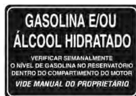
A etiqueta adesiva acima fica colocada na portinhola do bocal do tanque.
