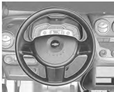
Para veículos equipados com airbag, pressionar qualquer ponto com o símbolo
