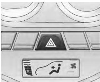
Pressione este botão localizado no painel de instrumentos próximo do sistema de controle de ventilação e ar condicionado, para fazer com que as luzes indicadoras dos sinalizadores de direção dianteiros e traseiros pisquem. Isto avisa os outros que você tem uma emergência e só deve ser utilizado com o carro parado. Pressione novamente para desligar o pisca-alerta.
