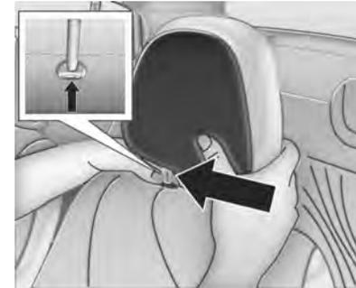
Para ajustar o apoio de cabeça pressione o botão de destravamento (seta) e deslize o apoio de cabeça ajustando-o com as mãos para cima ou para baixo. O apoio de cabeça pode ser posicionado em três alturas diferentes.
