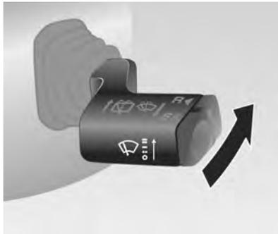
Funciona somente com a ignição ligada. O limpador e o lavador do vidro traseiro funcionam em ambas as posições da alavanca.
