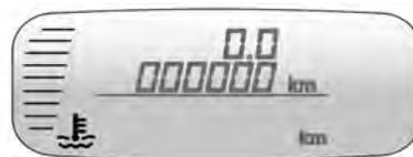
Exibe a temperatura do líquido de arrefecimento do motor.
