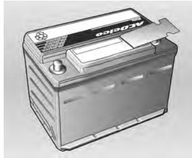
A bateria ACDelco que equipa o seu veículo dispensa manutenção periódica. Se o veículo não for usado durante 30 dias ou mais, desconecte o cabo do pólo negativo da bateria para não descarregá-la.
