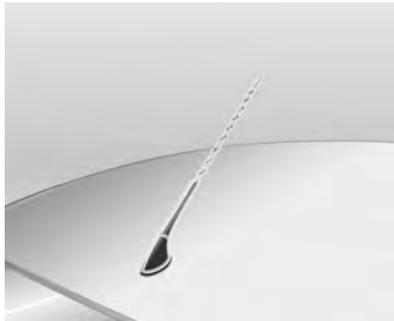
A antena do rádio localiza-se na parte dianteira do teto. Para remover, gire no sentido anti-horário. Para instalar a antena gire no sentido horário.
