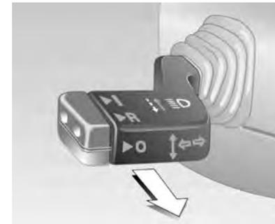
É utilizado para enviar sinais de luz com o farol alto. Para fazer isto, puxe a alavanca no sentido do volante de direção. O lampejador do farol alto pode ser operado com o sinalizador de direção em funcionamento.
